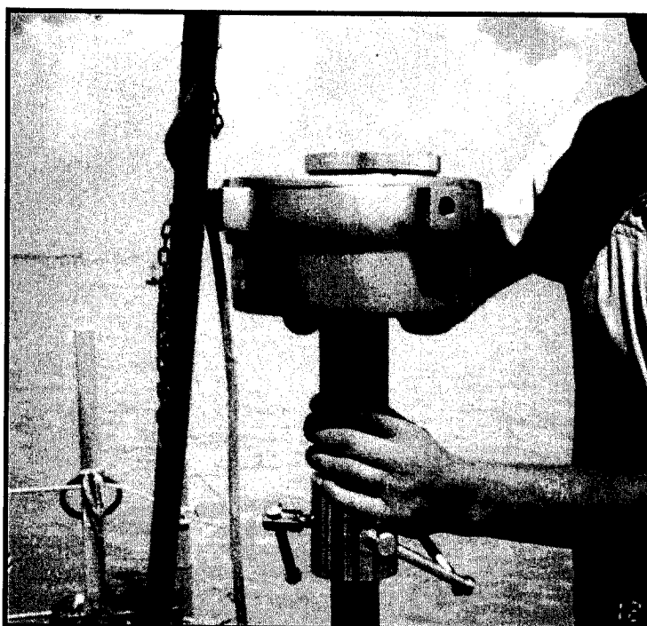
EQUIPO DE VELETA DE CORTE PARA ENSAYOS IN SITU EN SUELOS BLANDOS
