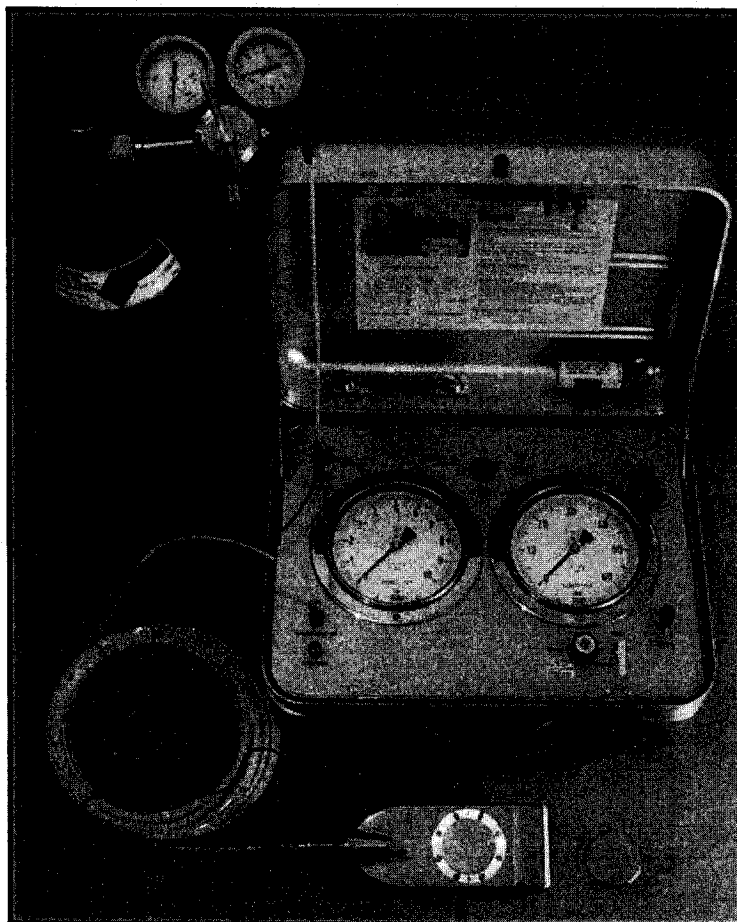
DILATOMETRO DE MARCHETTI PARA ENSAYOS IN SITU EN SUELOS Y EN ROCAS
