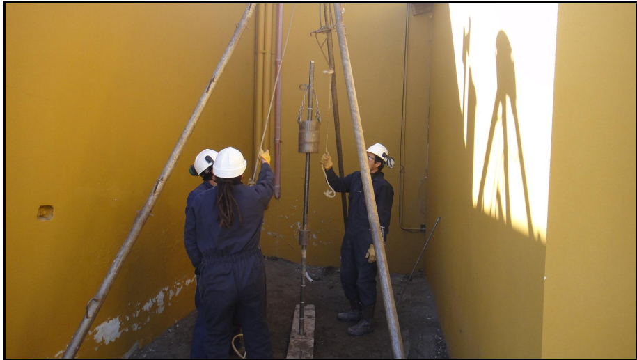
Ensayo SPT en Sondeo 1
