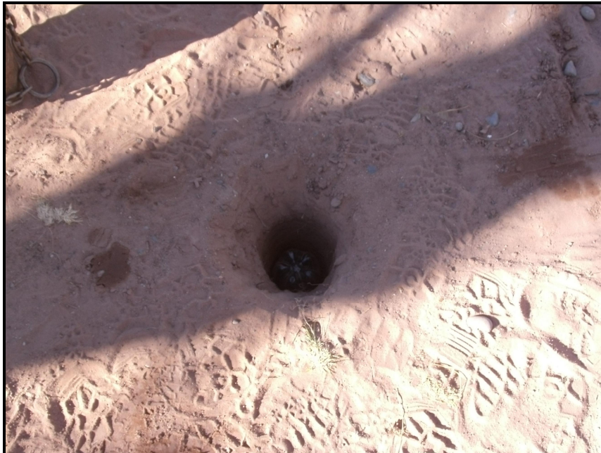
Sondeo 2 finalizado y obstruido para su preservación.
