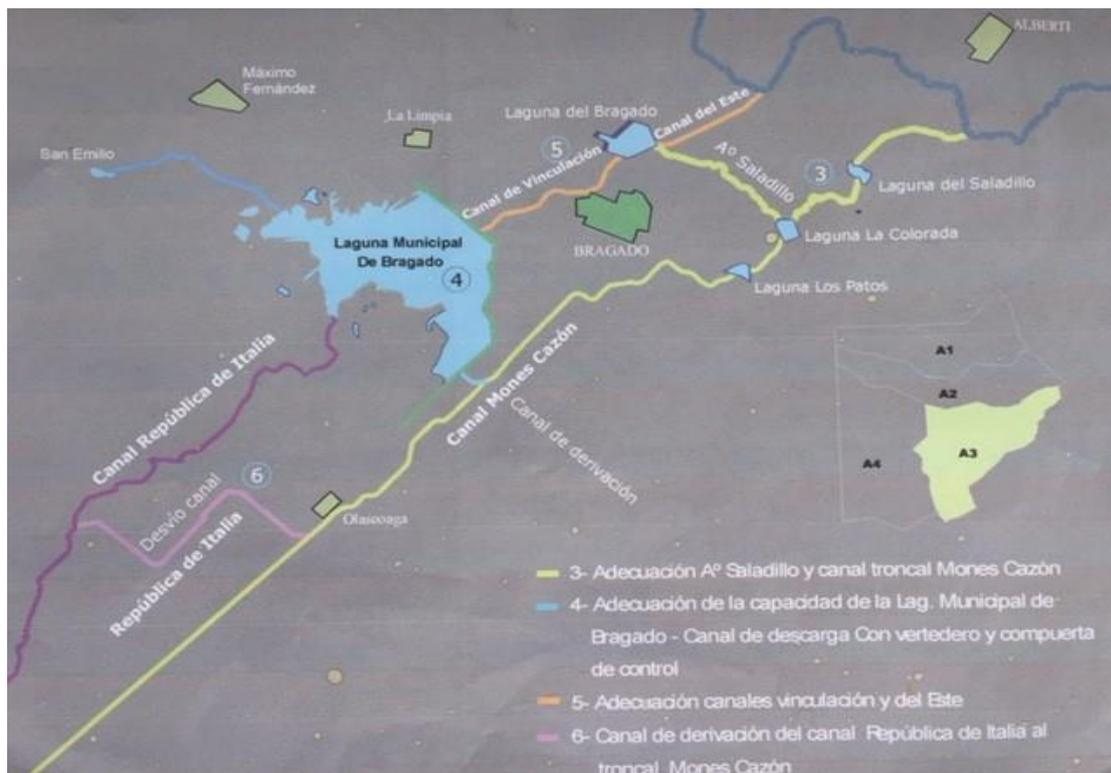
La obra consiste en la ejecución de un terraplén de cierre para la Laguna Municipal de Bragado de aproximadamente 18 km de longitud y altura máxima 5 m y UNA obras de hormigón formadas por la Obra de Control, que descarga al Canal de Vinculación.
