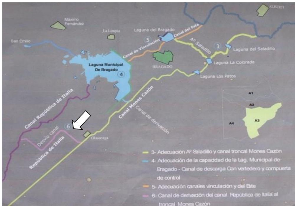
En la documentación gráfica que se adjunta, se indica la ubicación general de las obras, tanto del Partidor de Caudales, del canal, como de las obras de arte para admisión de caudales y puentes.
