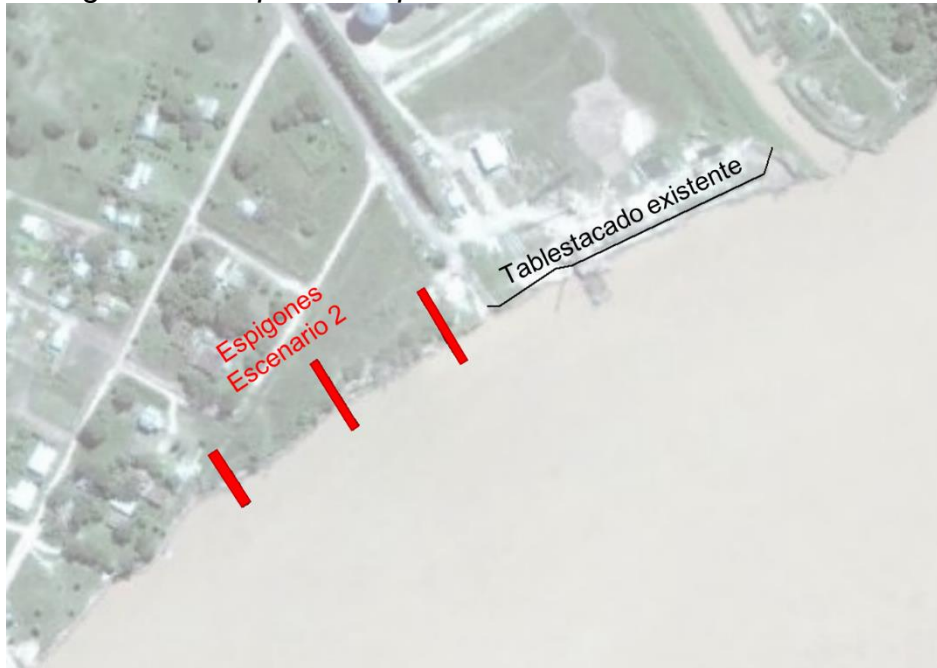
Figura 32: Esquema de protección transversal. Escenario 2
