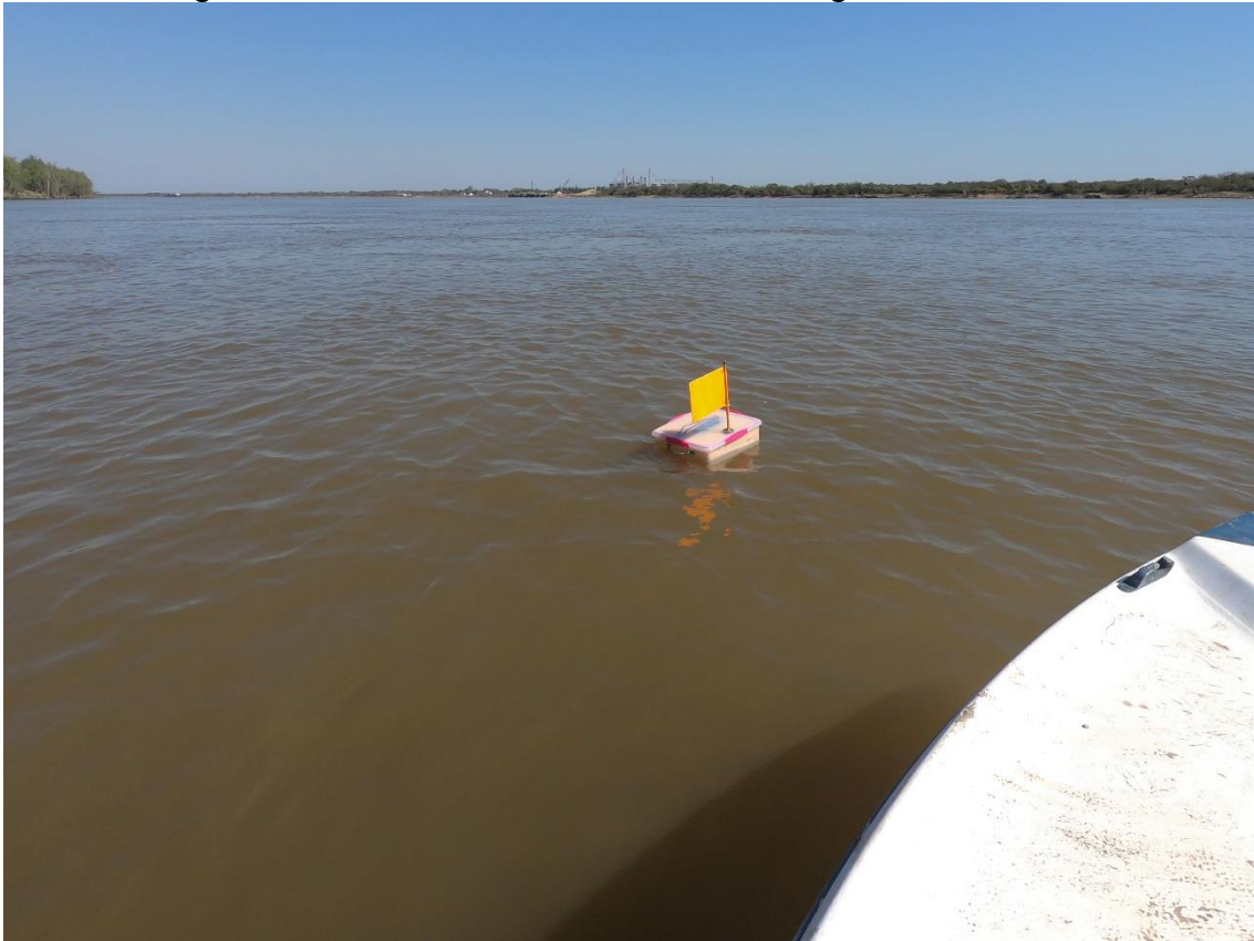
Figura 17: Flotador a la deriva con GPS registrando el track
