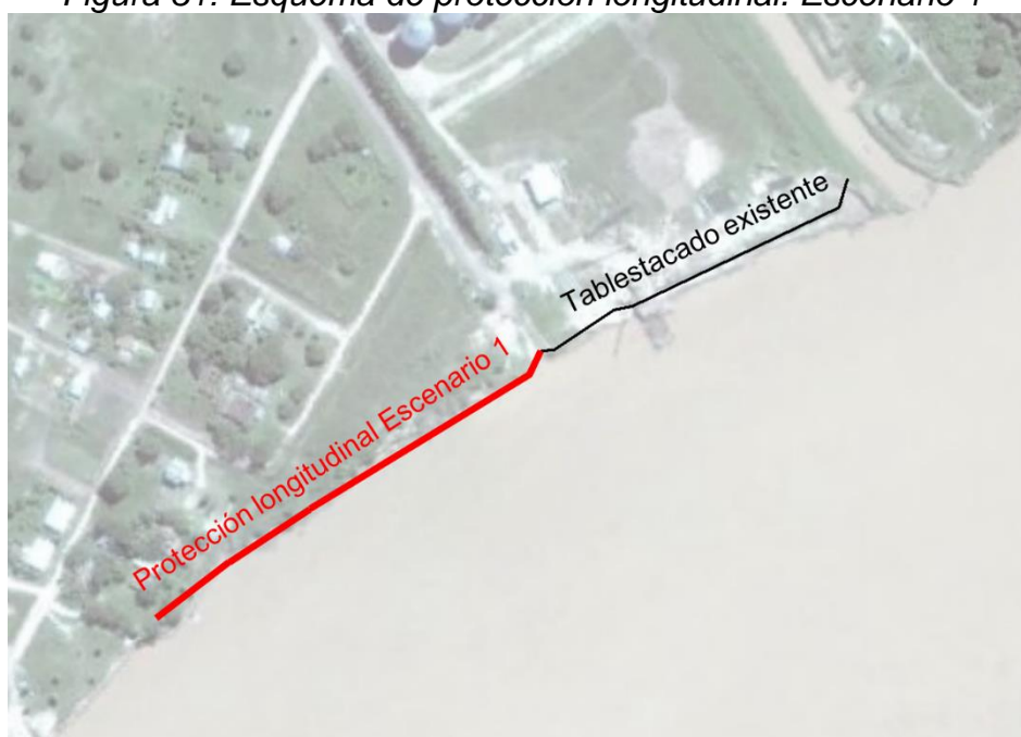
Figura 31: Esquema de protección longitudinal. Escenario 1
