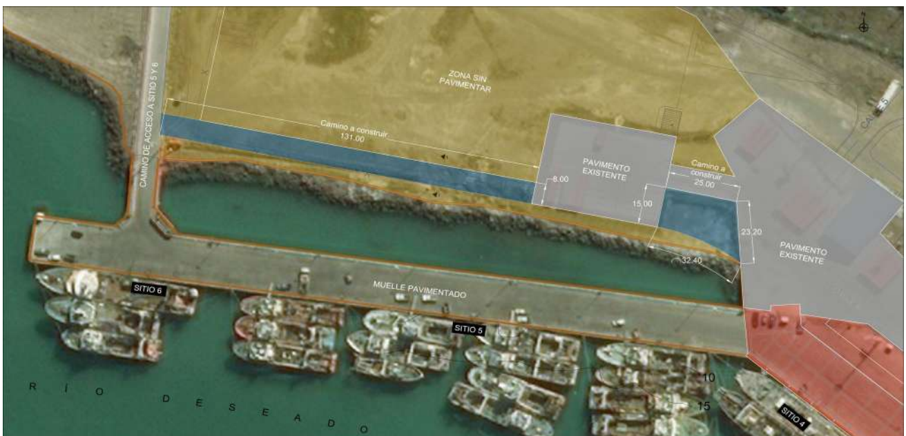
Figura 43: Planta Pavimento de Conexión con Sitio 5-6
