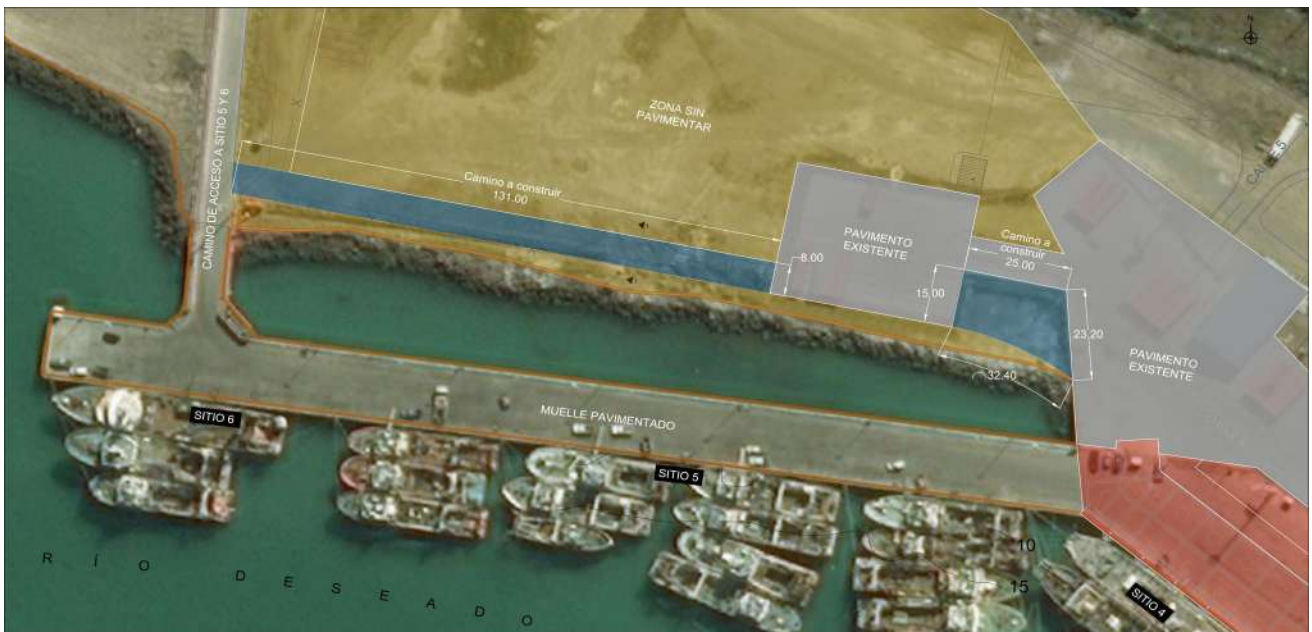
Figura 43: Planta Pavimento de Conexión con Sitio 5-6
