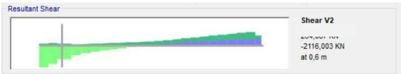
Figura 33: V2 Máximo. Viga VT-2.*
