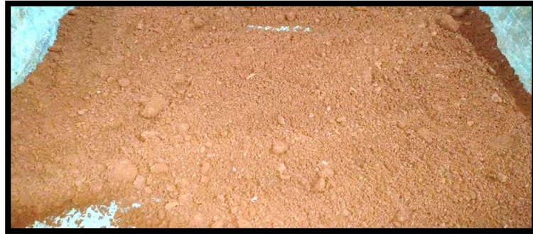
Imagen N°3: Suelo Tipo Limo Arcilloso Rojizo
