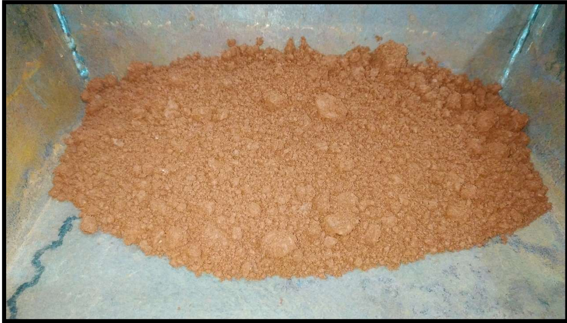
Imagen N°10: Suelo limo arcilloso rojizo en sondeos.
