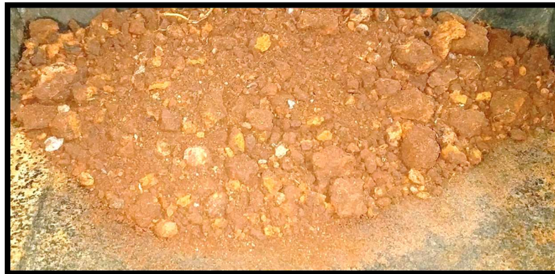
Imagen N°4: Suelo Tipo Rojizo con Suelo Saprolito
