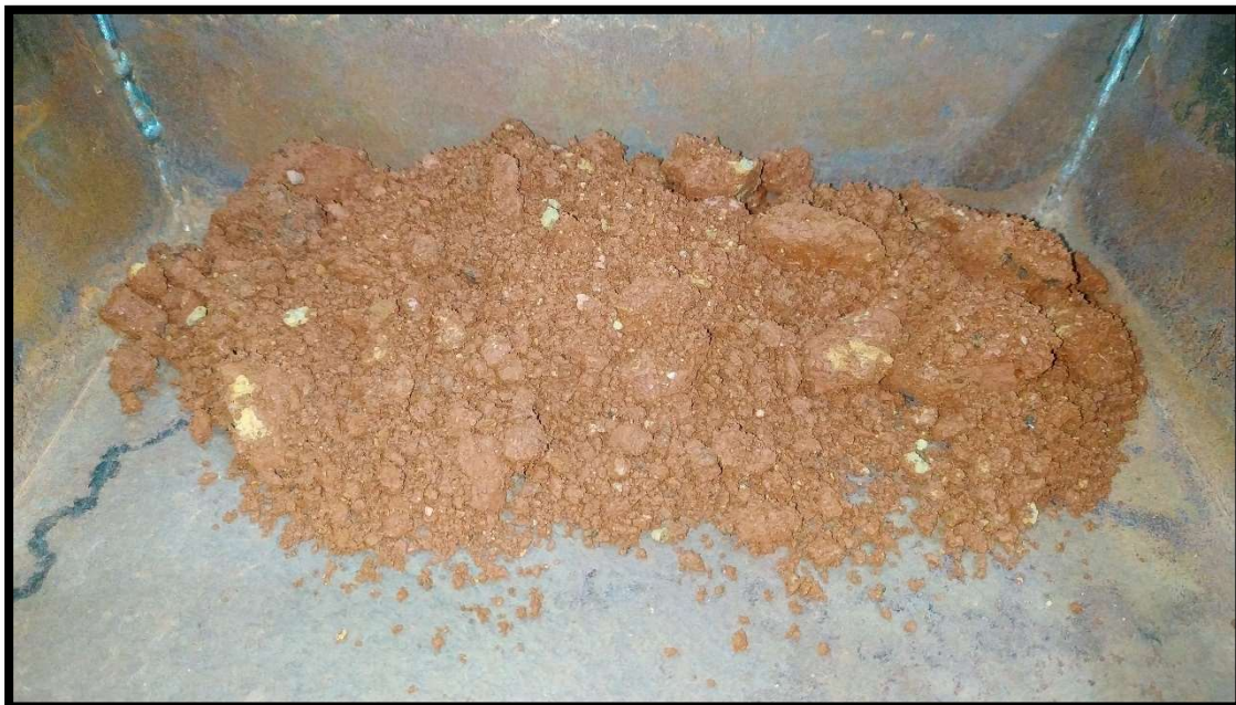
Imagen N°11: Suelo limo arcilloso rojizo con suelo sapolito en sondeos.
