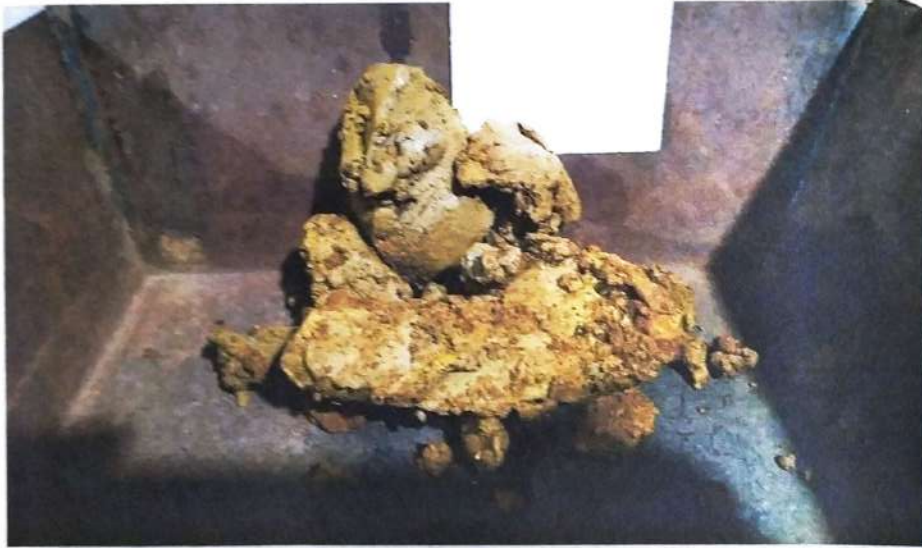
Imagen N°6: Suelo del Sondeo S1 (2,00 – 3,20)
