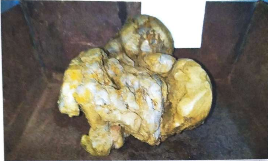
Imagen N°5: Suelo del Sondeo S2 (1,00 – 2,00)
