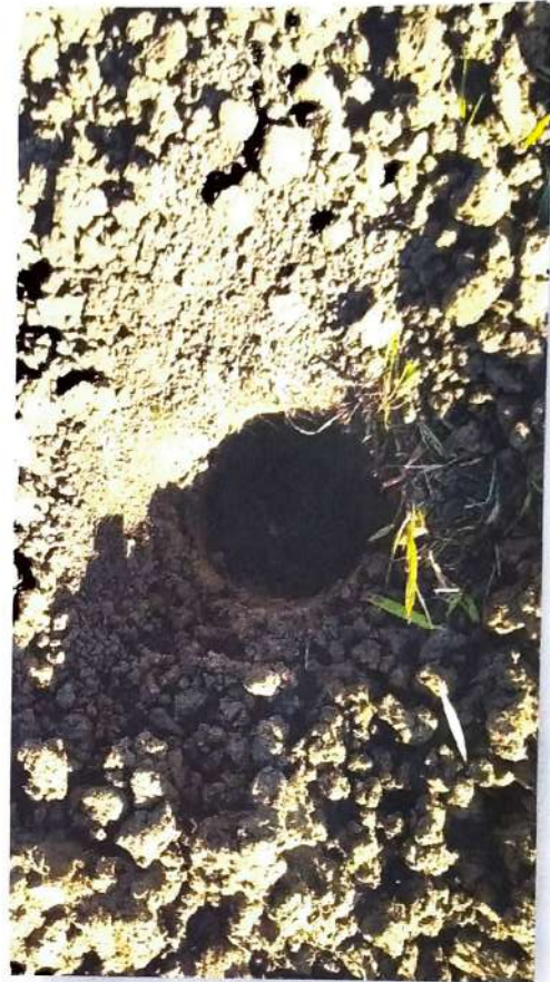
Imagen N°3: Presencia de agua en el sondeo S2
