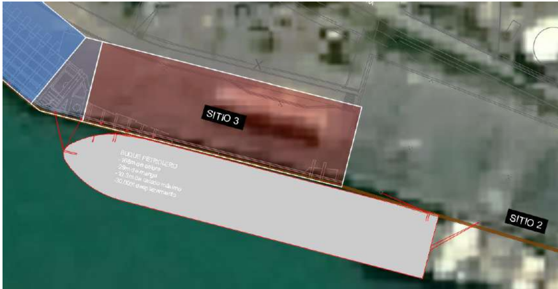
Figura 5: Amarre del Buque Petrolero de 168m de eslora
