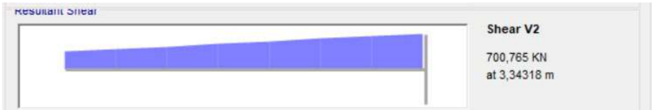
Figura 20: V2 Máximo. Viga VF.
