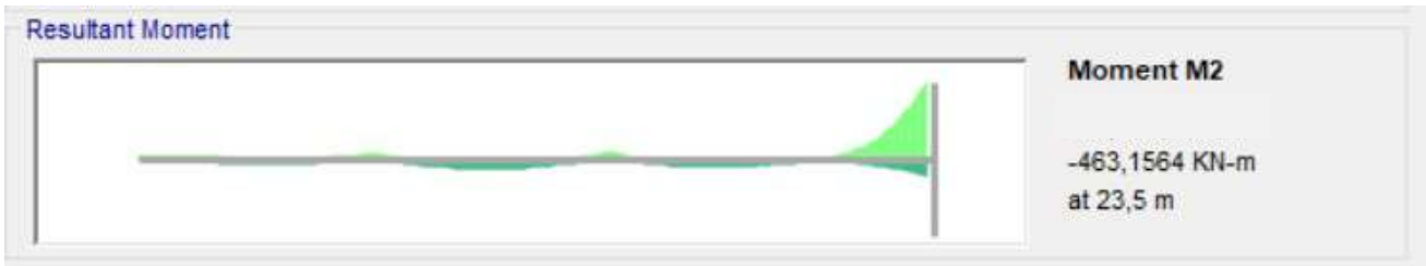
Figura 31: M2 Negativo Máximo. Viga VT-1.
