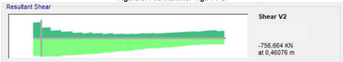
Figura 28: V3 Máximo. Viga VF.
