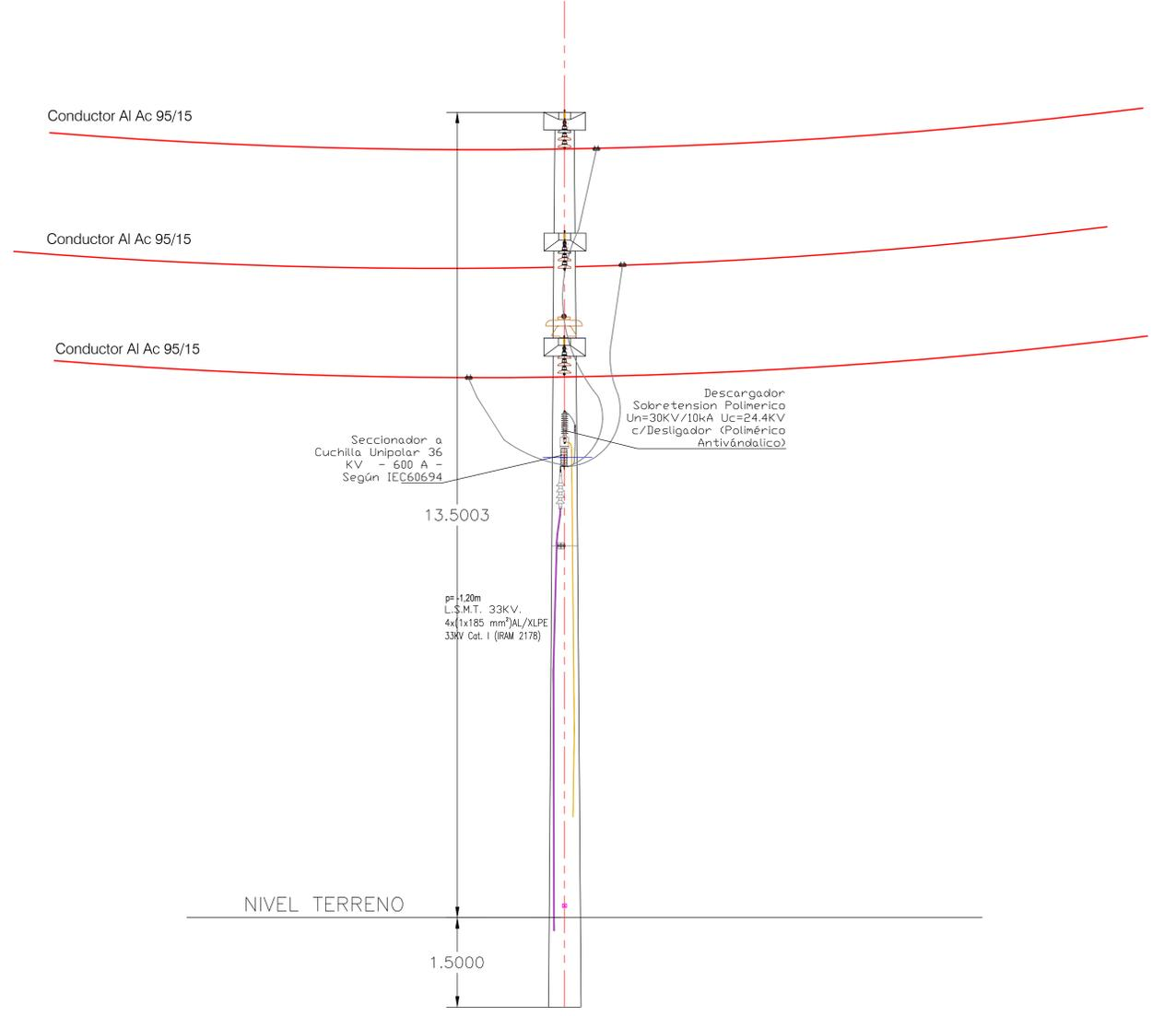
Seccionador a Cuchilla Unipolar 36 KV - 600 A - Según IEC60694
