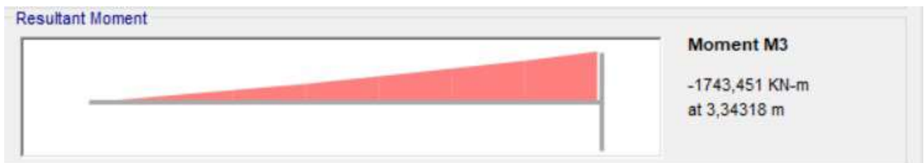
Figura 19: M3 Negativo Máximo. Viga VF.
