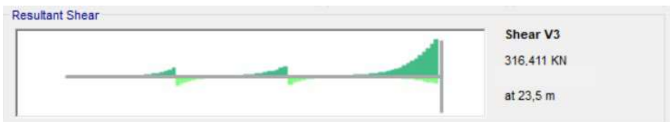
Figura 34: V3 Máximo. Viga VT-1.
