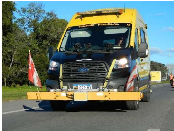
EQUIPO TPL MONTADO SOBRE VEHÍCULO
