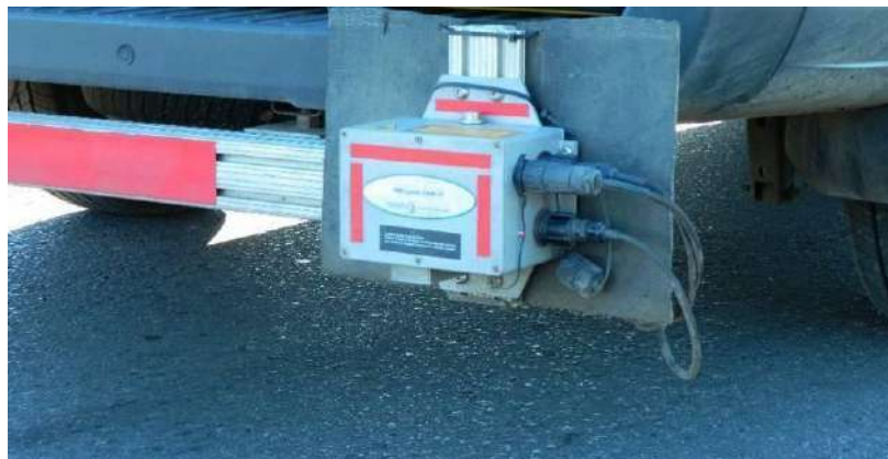
RUGOSÍMETRO LÁSER MONTADO SOBRE EQUIPO MULTIFUNCIÓN
