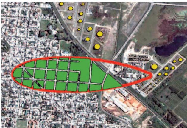
Otra forma de presentar la pluma de dispersión, como se observa, es mediante una figura proyectada sobre la imagen satelital (el área afectada se presenta como una forma fusiforme verde opaca).
