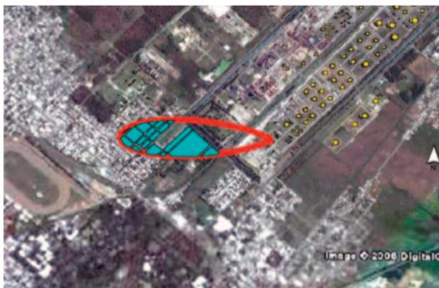
En la imagen se ve una pluma de dispersión de Fluoruro de Hidrógeno generada por el programa ALOHA a partir de un tanque de la destilería de YPF Ensenada. Según el Censo 2001, el aglomerado urbano del Gran La Plata tenía 694.253 habitantes.
