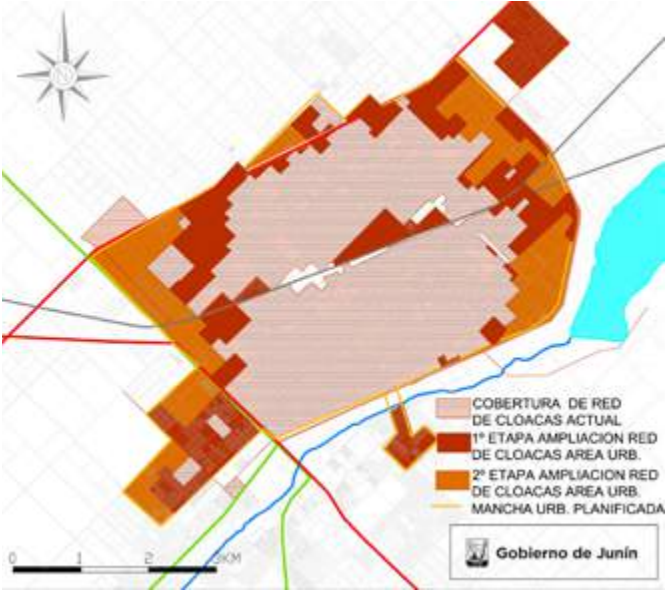
Cobertura de Red de Cloacas Actual 1ra Etapa: Ampliación Red Cloacas Área Urbana 2da Etapa: Ampliación Red Cloacas Área Urbana
