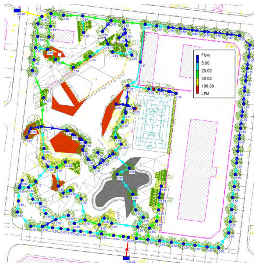
Imagen 45 Consumos en los nodos y caudales en los tramos de la Plaza 73 (l/min).
